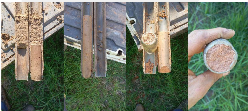
Figura 3: Material encontrado no amostrador durante a realização da sondagem SPT 01.
