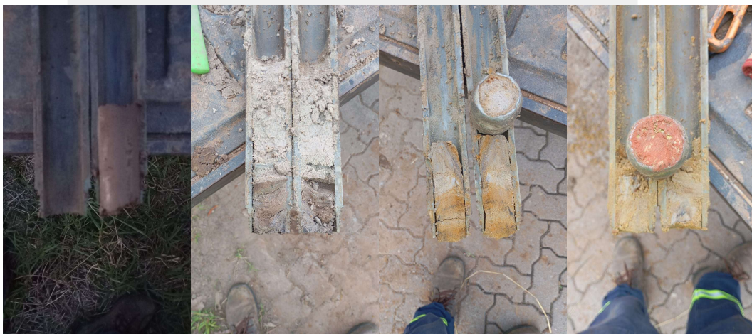
Figura 5: Material encontrado no amostrador durante a realização da sondagem SPT 04.
