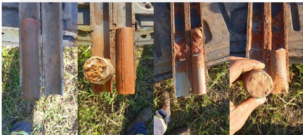
Figura 4: Material encontrado no amostrador durante a realização da sondagem SPT 02.
