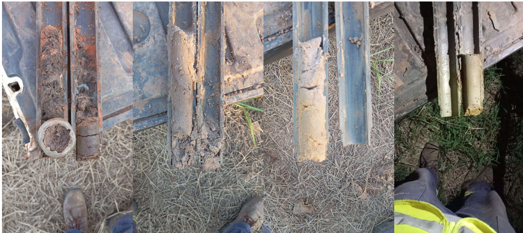
Figura 5: Material encontrado no amostrador durante a realização da sondagem SPT 03.
